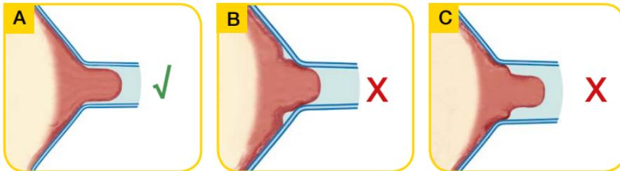
È importante che la coppa per il seno aderisca in modo corretto. La giusta coppa per il seno assicura comfort ed efficienza nell'estrazione del latte. La figura A sopra illustra la coppa per il seno della misura corretta. La coppa per il seno in figura B è troppo piccola, quella in figura C troppo grande.
