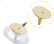
Inserire il supporto (con la guarnizione O-ring) nel foro sul lato superiore del diaframma. Il supporto e il diaframma sono componenti dell'impugnatura del tiralatte.
