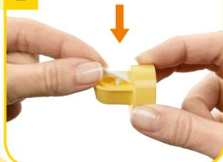
Tempatkan katup membran dalam posisi horizontal pada kepala katup. Dengan hati-hati dorong knop di bagian belakang membran ke dalam lubang terkecil dari kepala sampai menyatu. Membran harus menempel di bagian atas.
