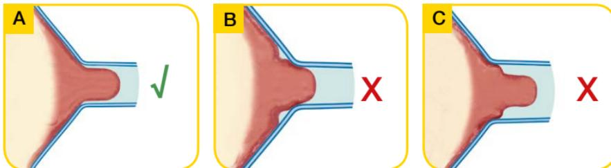
Het is belangrijk dat het borstschild goed aansluit. Een goed passend borstschild zorgt voor comfortabel en efficiënt afkolven. In figuur A hierboven ziet u een borstschild met de juiste maat. Het borstschild in figuur B is te klein, dat in figuur C te groot.
